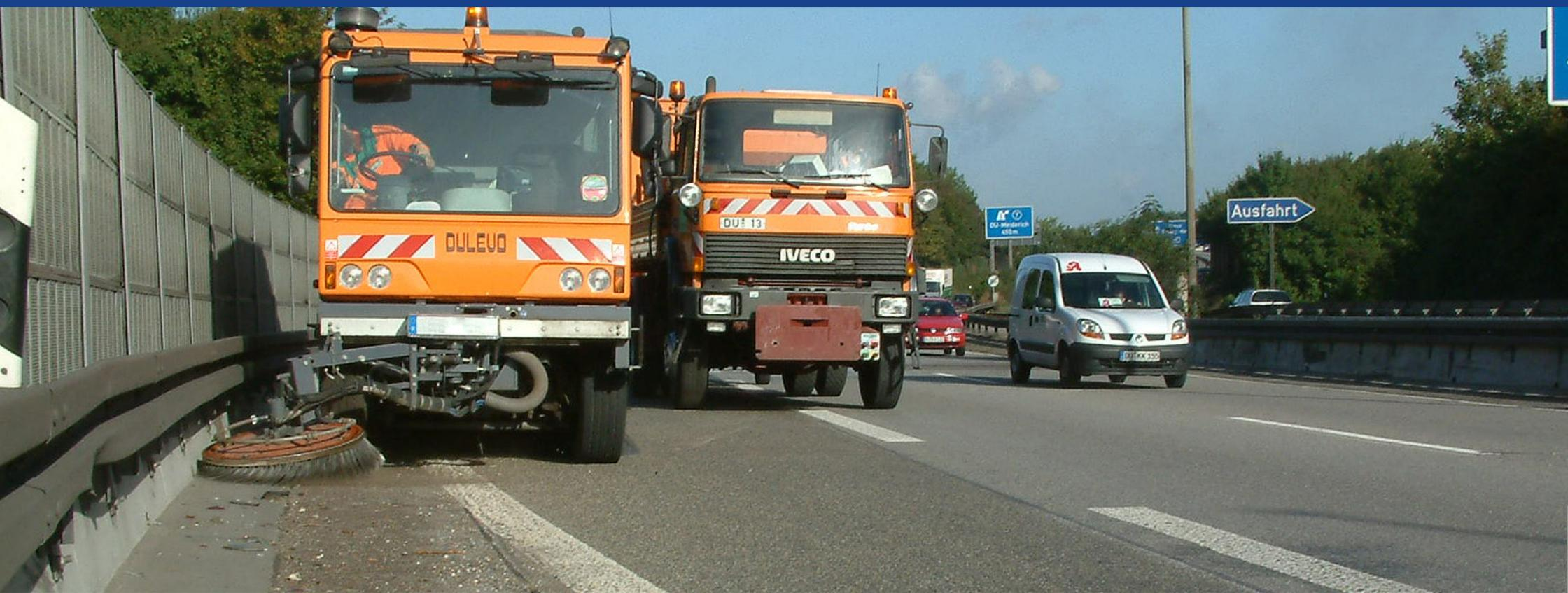
**E**n coopération avec Gore®, Dulevo a développé la seule balayeuse au monde avec filtration complète des particules fines. Ce système mécanique d'aspiration/filtration avec la technologie exclusive de Gore® assure une réduction totale des particules PM10.
