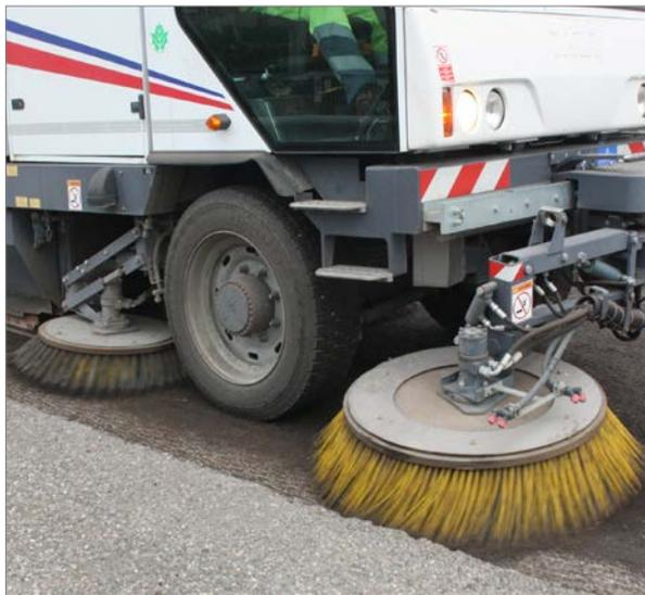
Le balai avant et son mouvement complet à 180 degrés est un outil auxiliaire indispensable pour balayer les coins, caniveaux et offre une capacité de travail de grande largeur.
