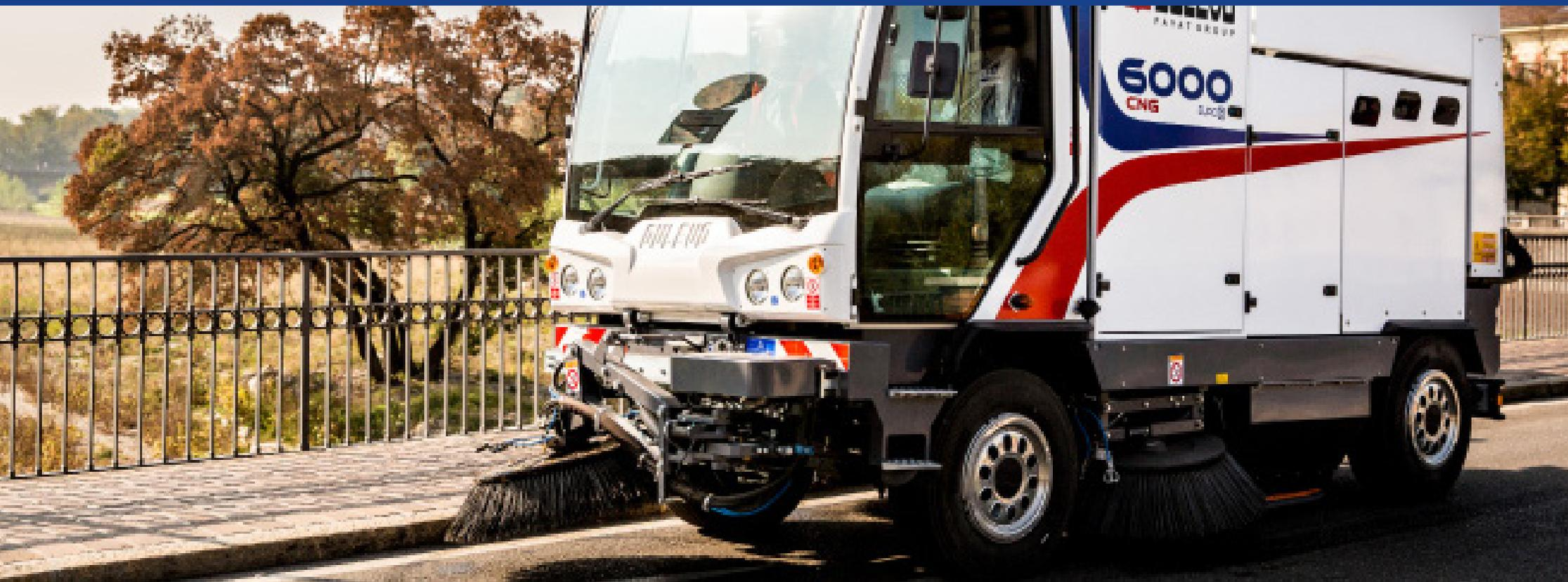
En coopération avec Gore®, Dulevo a développé la seule balayeuse au monde avec filtration complète des particules fines. Ce système mécanique d'aspiration/filtration avec la technologie exclusive de Gore® assure une réduction totale des particules PM10.
