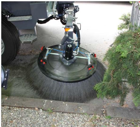
Le balai avant et son mouvement complet à 180 degrés est un outil auxiliaire indispensable pour balayer les coins, caniveaux et offre une capacité de travail de grande largeur. Le système d'élévation de la benne permet la décharge des déchets dans les conteneurs, les camions ou les grands compacteurs d'ordures. Un grand choix d'options augmente la diversité de fonctionnement de la Dulevo 6000 CNG partout et à tout moment.
