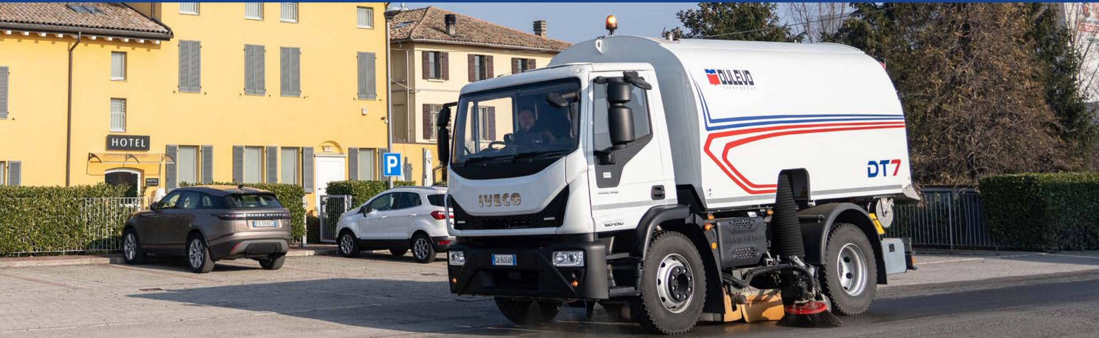
L'équipement du Dulevo DT7 peut bien sûr s'appliquer aux châssis de camions de différentes marques dont : Iveco, Scania et Mercedes. Le large choix d'options et d'accessoires permet également une personnalisation sur mesure en fonction des besoins de balayage spécifiques. Pour des demandes particulières et/ou des conditions d'utilisation, il est possible d'évaluer la possibilité de monter des équipements et accessoires spécifiques, étudiés et conçus spécifiquement pour le client.
